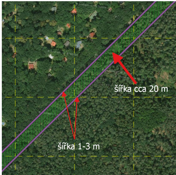
Obr. 17: Příklad použití protipožárních izolačních pruhů s vloženým protipožárním pásem v borových porostech oddělující chatovou kolonii. Pro názornost zobrazena čárkovaně hektarově síť
